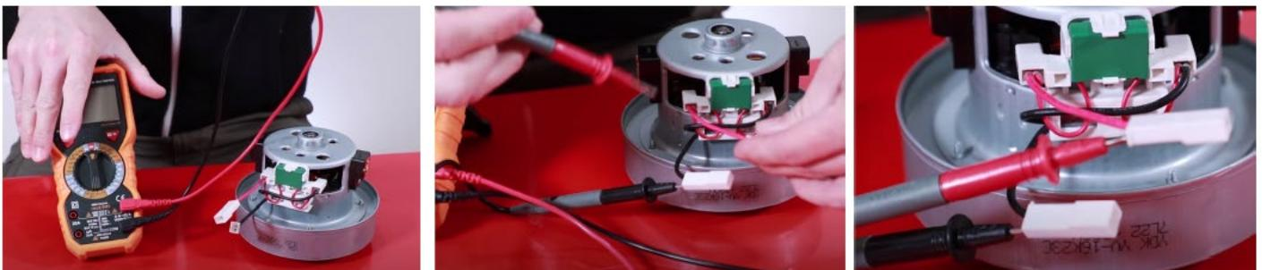
Ensuite, on met les fiches du multimètre, dans les connecteurs du moteur.
