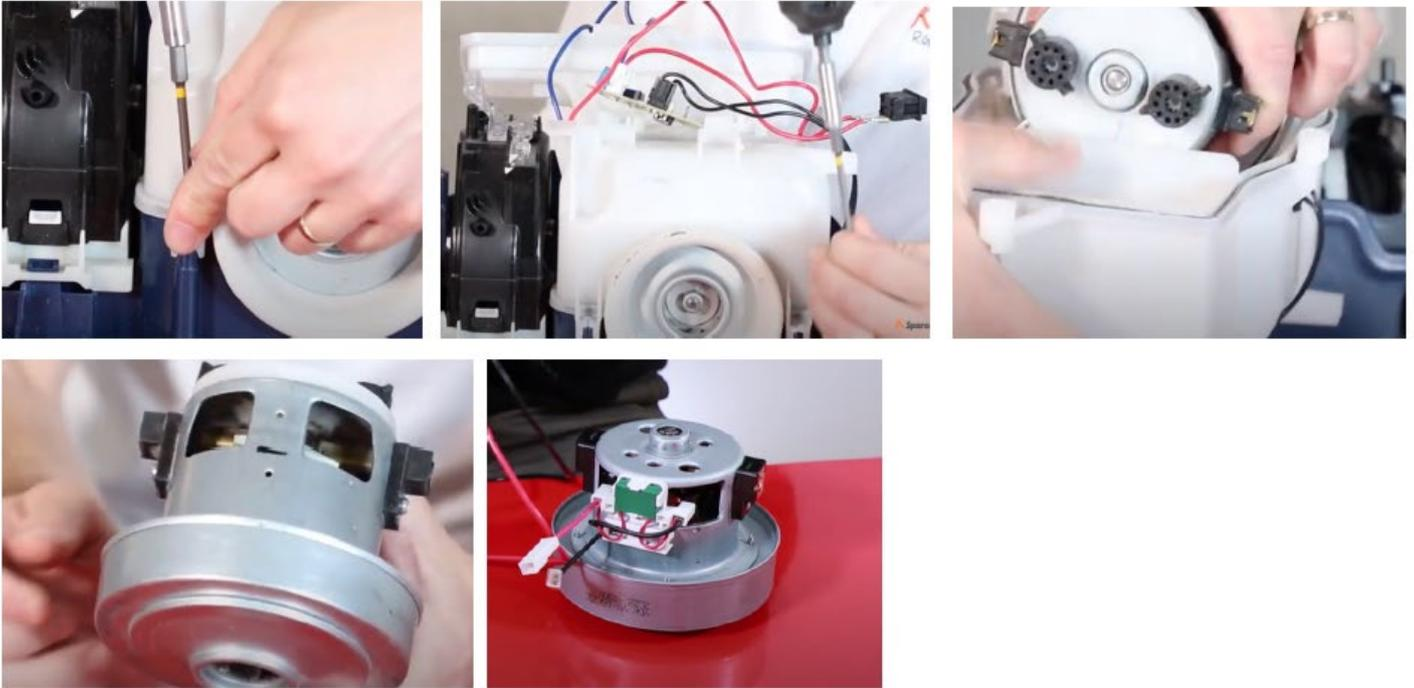
A l'intérieur, il y a une partie qui est fixe, qui s'appelle le stator, et une autre en cuivre qui tourne, qui s'appelle le rotor.
