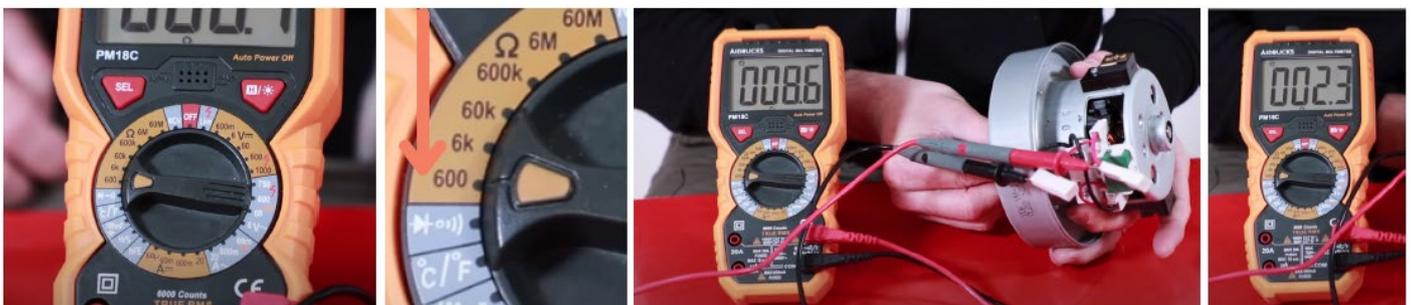
On met le multimètre en position ohmmètre, sur la valeur la plus basse. Si le moteur fonctionne, le multimètre affiche une valeur autour de 8 ohms. En faisant tourner le moteur à la main, la valeur doit évoluer, elle doit grandir quand le moteur tourne, et baisser quand il ralentit.
